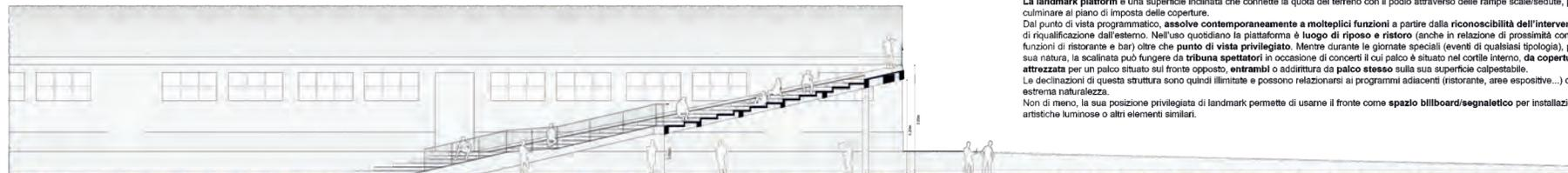
La **landmark platform** è una superficie inclinata che connette la quota del terreno con il podio attraverso delle rampe scale/sedute, per culminare al piano di imposta delle coperture.
